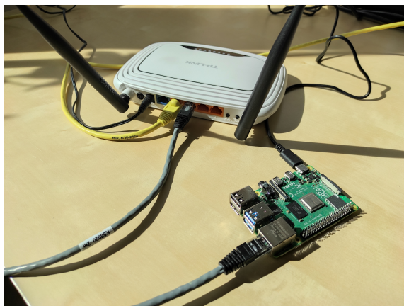
Obr. 5.1: Ukážka pripojenia Raspberry Pi do domáceho smerovača [8].
